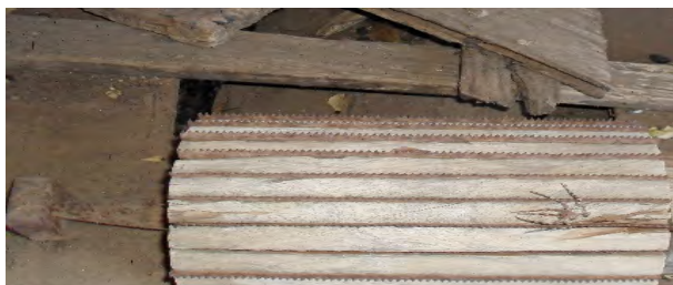
Figura 8 – Roldana triturador de mandioca, localizada na casa de farinha da Fazenda Araras, no município de São João do Cariri.
