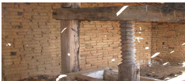
Figura 7 – Prensa (objeto feito para espremer a mandioca), localizada na Fazenda Araras, termo de São João do Cariri. Fonte: Arquivo do autor.
