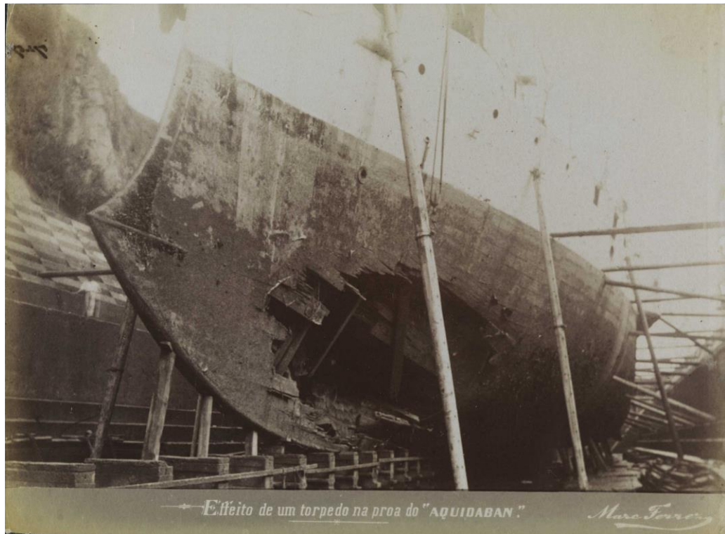
Imagem 12 - Efeito de um torpedo na proa do "Aquidaban"
